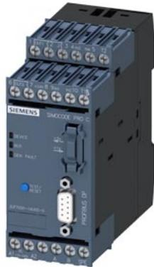
equipamento de base SIMOCODE pro C, interface PROFIBUS DP 12 MBit/s, RS-485, 4E/3A livremente parametrizável, US: 110...240 V CA/CC, entrada para ligação a termistor saídas de relé monoestáveis
