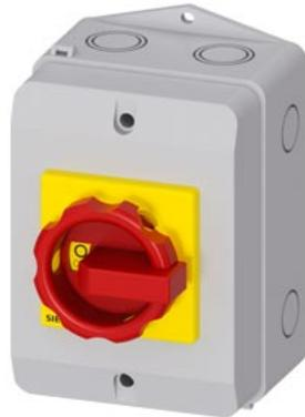
SETRON, seccionador de corte em carga 3LD, chave de PARADA DE EMERGÊNCIA, 3 polos, lu: 32 A, potência de operação/a CA-23 A a 400V: 11,5 kW, encapsulamento com material isolante para união roscada métrica, acionamento rotativo, vermelho/amarelo
