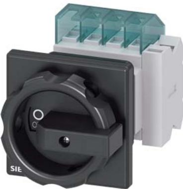
SENTRON, seccionador de corte em carga 3LD, interruptor principal, de 3 polos, Iu: 16 A, potência de operação/ a CA-23 A a 400V: 7,5 kW, fixação dianteira, 1NF, 1NA, acionamento rotativo, preto, fixação central 22,5mm de manípulo
