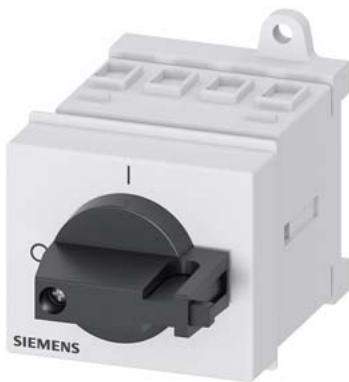
SENTRON, seccionador de corte em carga 3LD, interruptor principal, de 3 polos, I<sub>u</sub>: 16 A, potência de operação/ a CA-23 A a 400V: 7,5 kW, instalação da distribuição, acionamento de manípulo, preto, manípulo direto no interruptor
