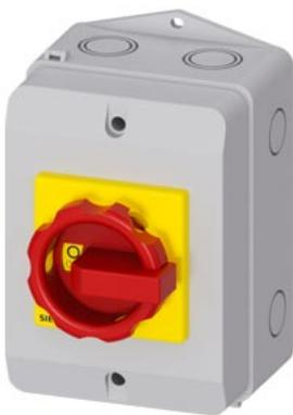
SENTRON, seccionador de corte em carga 3LD, chave de PARADA DE EMERGÊNCIA, 3 polos, lu: 16 A, potência de operação/a CA-23 A a 400V: 7,5 kW, encapsulamento de material isolante para sist. métrico união roscada, 1NF, 1NA, acionamento rotativo, vermelho/amarelo
