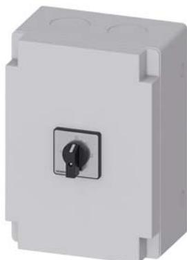
SETRON, seccionador de corte em carga 3LD, comutador, de 3 polos, Iu: 63 A, potência de operação/a CA-23 A a 400V: 22 kW, encapsulamento com material isolante para união roscada métrica, acionamento de manípulo, preto
