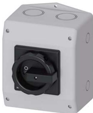
SETRON, seccionador de corte em carga 3LD, interruptor principal, de 6 polos, lu: 25 A, potência de operação/ a CA-23 A a 400V: 9,5 kW, encapsulamento com material isolante para união roscada métrica, acionamento rotativo, preto
