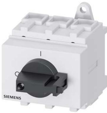
SENTRON, seccionador de corte em carga 3LD, interruptor principal, de 3 polos, I<sub>u</sub>: 63 A, potência de operação/ a CA-23 A a 400V: 22 kW, instalação da distribuição, acionamento de manípulo, preto, manípulo direto no interruptor
