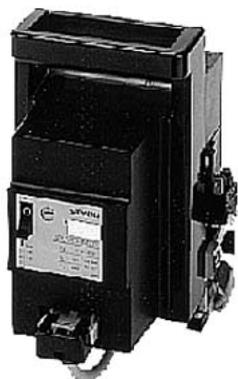
SETRON, seccionadora-fusível sob carga 3NP5, de 3 polos, NH00, 160 A, para estrutura e instalação em placa de montagem, com ligação rápida, conexão parafusada, monitorização dos fusíveis: via 3RV, interruptor auxiliar em seccionador de corte em carga: 1NA+1NF, interruptor auxiliar para monitorização dos fusíveis: 1NA+1NF
