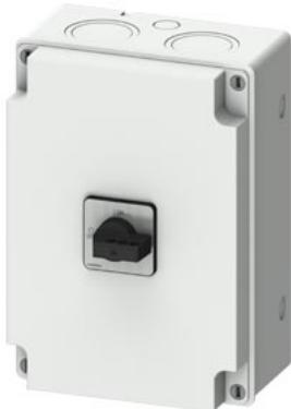
seccionador de corte em carga SENTRON 3LD na carcaça, interruptor manutenção e reparo com chapa de blindagem EMC, de 3 polos, Iu: 100A, CA23A 400V a 50/60Hz: 37kW em oper. conversor frequência: CA20 400V a 0-550Hz: 37kW, 1NA+1NF, em avanço 20-150ms, encapsulamento com material isolante para união roscada métrica, acionamento de manípulo, preto, bloqueável na pos. 0 e I, incl. braçadeiras blindadas e braçadeiras de mangueira
