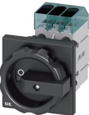
seccionador de corte em carga 3LD3, I<sub>n</sub> 63 A interruptor principal 3 polos potência nominal de operação a CA-23 A a 400V 22,0 kW fixação frontal interruptor de base com fixação de orifício central 22,5mm acionamento de manípulo preto 66x66mm
