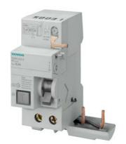
RC unit for 5SL4, 2-pole, type AC, In: 40 A, 300 mA, Un AC: 230 V
