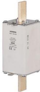
elemento de fusível PV, com contatos de faca, NH3L, In: 500 A, gPV, Un CC: 1000 V, indicador frontal
