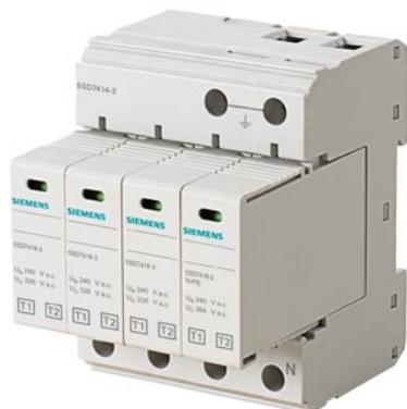
para-raios T1/T2, UN 240/400V, UC 335/264V CA, módulos de proteção encaixáveis, circuito 3+1 (TN-S, TT), largura 72mm
