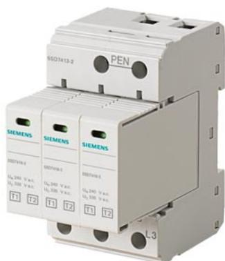
para-raios T1/T2, UN 240/400V, UC 335V CA, módulos de proteção encaixáveis, circuito 3+0 (TN-C), largura 54mm
