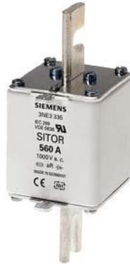
elemento de fusível SITOR, com contatos de faca ranhurados, NH3, In: 560 A, gR, Un CA: 690 V, Un CC: 440 V, indicador frontal
