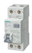
RCBO, 6 kA, 1P+N, Type AC, 300 mA, B char., In: 6 A, Un AC: 230 V
