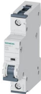
disjuntor da linha 230/400V 10kA, de 1 polo, C, 25A, P=70mm
