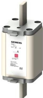
elemento de fusível NH, NH1, In: 125 A, gG, Un CA: 500 V, Un CC: 440 V, indicador combinado, pegas isoladas
