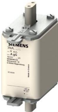
elemento de fusível NH, NH00, In: 100 A, gG, Un CA: 500 V, Un CC: 250 V, indicador frontal, pegas condutoras de tensão
