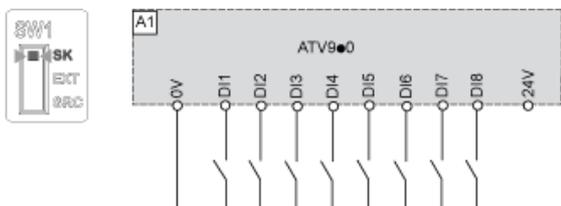
Comutador definido para a posição EXT utilizando uma fonte de alimentação externa para DIs
