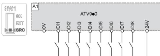
Comutador definido para a posição SRC (Fonte) e uso de uma fonte de alimentação externa para DIs
