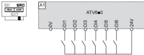
Comutador definido para a posição SRC (Fonte) e uso de um fornecimento externo de energia para DIs
