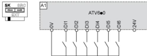
Comutador definido para a posição EXT utilizando um fornecimento externo de energia para DIs
