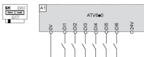
Comutador definido para a posição EXT utilizando um fornecimento externo de energia para DIs
