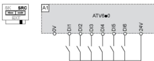
Comutador definido para a posição SRC (Fonte) e uso de um fornecimento externo de energia para DIs
