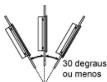
Ao instalar este produto na posição inclinada com inclinação superior a 30°, a temperatura ambiente não deve exceder 40°C (104°F). Pode ser necessário usar resfriamento com ar forçado (ventoinha, A/C) para garantir que a temperatura ambiente de funcionamento seja 40 °C (104 °F) ou inferior.
