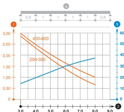
Diagrama de cargas do caminho de cabos para grandes cargas do tipo WKSG 160
