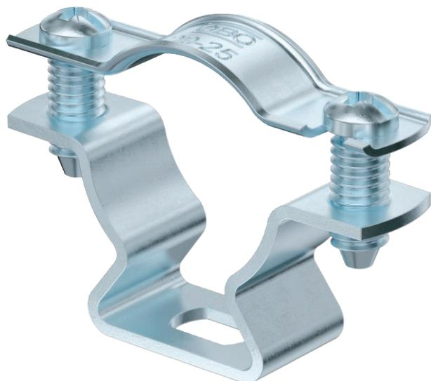
Abraçadeira distanciadora para montagem de tubos e cabos na parede, teto e chão. Com tampa de travamento automático. Fixação pela ranhura. Adequada para montagem com pistola de pregos ou pistola para parafusos, a partir do tamanho 20 das abraçadeiras. Aprovada para a manutenção de funções de acordo com a DIN 4102 parte 12, classes de manutenção de funções E 30 a E90 (excetuando ALU).
