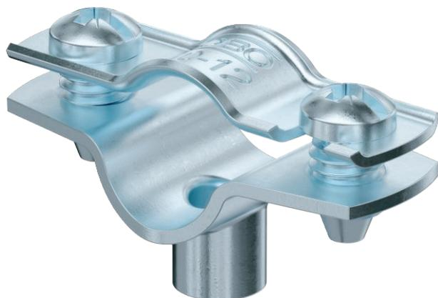
Abraçadeira distanciadora para montagem de tubos e cabos na parede, teto e chão. Com tampa de travamento automático. Fixação através de aplicação com rosca fêmea. Superfícies G e FT, a partir do tamanho 20 da abraçadeira, adequadas para montagem com pistola de pregos ou pistola para pinos.
