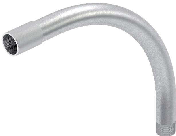
Ângulo de 90° para tubos de instalação elétrica conforme a EN 61386-1 com pontas roscadas de acordo com DIN EN 60423. Parede interior sem rebarbas.
