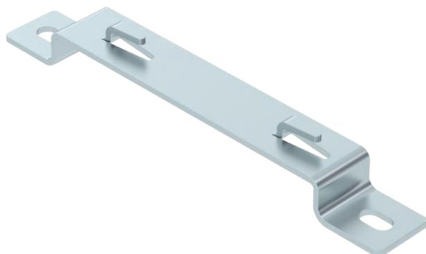
Distanciador para a montagem de caminhos de cabos em varão no chão ou na parede. Podem ser montados, no grampo separador, caminhos de cabos em varão do tipo GRM com uma altura lateral de 35, 55 e 105 mm.
