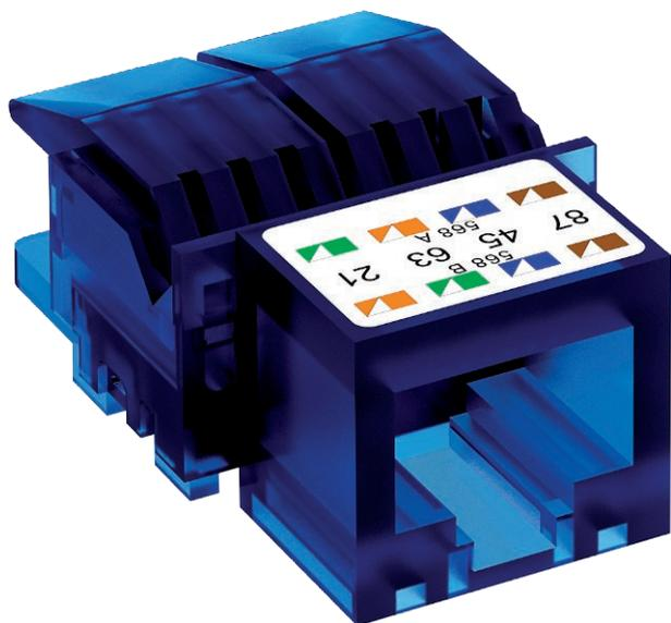
Conector com placa de suporte, cat. 6 não blindado, com uma slot RJ45. Inclui uma capa de proteção antipó, uma abraçadeira de fivela e instruções de montagem. Instalação em espelhos para conectores de dados do tipo DTG-2RM e DTS-2RM.
