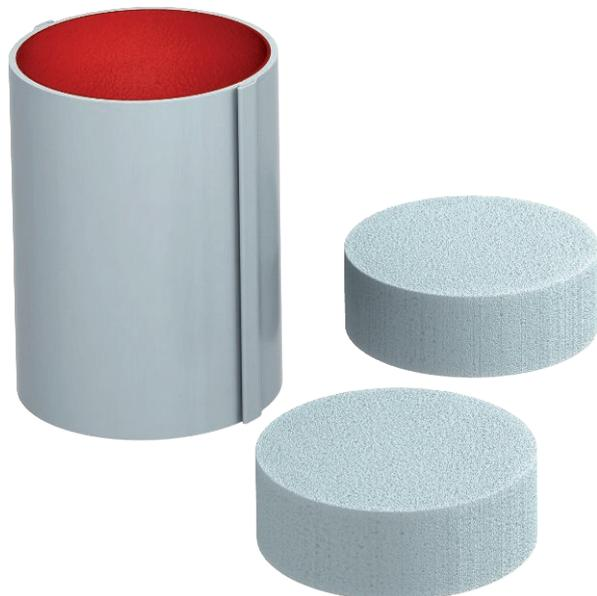
Proteção de tubo com revestimento interior e com fecho de clique. O espaço interior pode ser totalmente ocupado com cabos e tubos de instalação elétrica. Produto de construção com marcação CE, com certificação europeia conforme a ETA-13/0904 e homologação técnica geral alemã. Resistência ao fogo até 120 minutos.
