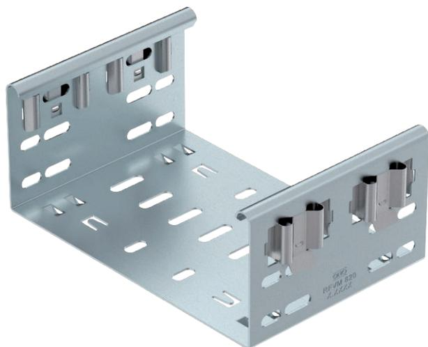
União Magic para ligação direta e sem parafusos de acessórios Magic com altura lateral de 85 mm. A união de acessórios está equipada com quatro grampos e pode ser utilizada também em montagem de um só lado, com dois grampos para a ligação direta a um caminho de cabos cortado. Para a ligação de caminhos de cabos cortado a acessórios será sempre necessário utilizar uniões rápidas Magic.
