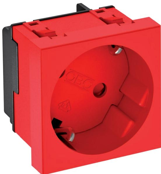
Tomada de contacto de segurança Simples 33°, com elevada proteção contra contacto, com ligadores rápidos, 2 polos, 16 A, 250 V~, com bornes de ligação em conformidade com a IEC 60884-1.
