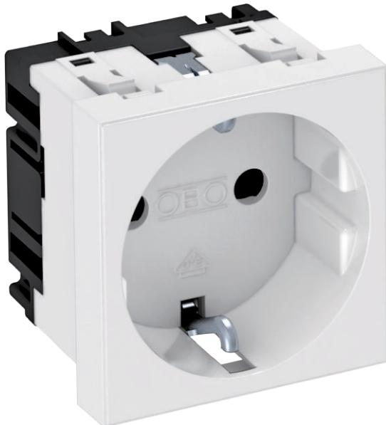
Tomada de contacto de segurança 1 módulo 0°, com elevada proteção contra contacto, com ligadores rápidos, 2 polos, 16 A, 250 V~, com bornes de ligação em conformidade com a IEC 60884-1.
