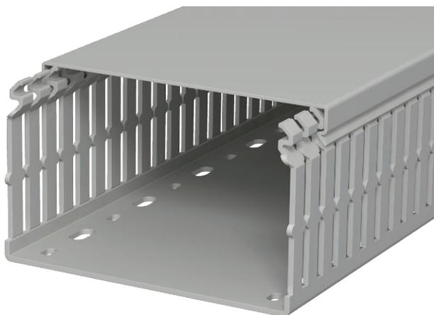
Calha de cablagem conforme DIN EN 50085-2-3 incl. tampa e base perfurada, com estreitamento das ranhuras laterais que impede a queda dos condutores.
