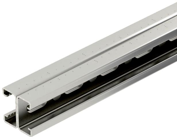
Perfil de montagem perfurado na base, para grandes cargas, e uma largura de rasgo de 22 mm. Versão dupla, isto é, com dois perfis interligados na base (soldados).
