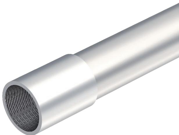
Tubo de instalação elétrica conforme EN 61386-1, com pontas roscadas de acordo com DIN EN 60423, para a proteção mecânica de cabos e condutores. Com parede interior sem rebarbas. Cada tubo já inclui uma união instalada.
