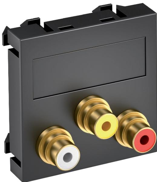
Suporte multimédia com três tomadas de ligação RCA para áudio-vídeo, saída de cabo plana, com campo de inscrição, três tomadas RCA com ligação soldada, codificação a cores em amarelo / vermelho / branco. Espelho com fixação por encaixe, adequada para a montagem horizontal e vertical em todo o sistema.
