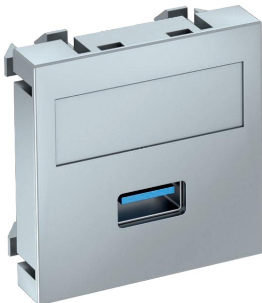
Suporte de multimédia com uma tomada de ligação USB 3.0, saída de cabo plana, com campo de inscrição, tomada USB 3.0, tipo A, com conexão de rosca. Espelho com fixação por encaixe, adequado para a montagem horizontal e vertical em todo o sistema.
