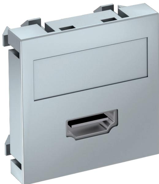
Suporte multimédia com uma tomada de ligação HDMI, saída de cabo plana, com campo de inscrição, tomada HDMI com conexão de rosca. Placa de suporte com fixação por encaixe, adequada para a montagem horizontal e vertical em todo o sistema.
