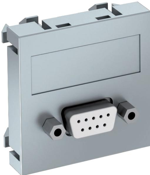
Suporte de multimédia com uma tomada de ligação D-Sub9, saída de cabo plana, com campo de inscrição, tomada D-Sub9 (RS232) com conexão de rosca. Espelho com fixação por encaixe, adequado para a montagem horizontal e vertical em todo o sistema.
