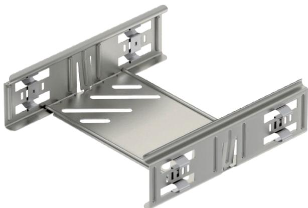
União de caminho de cabos em chapa com fixação rápida para a ligação, sem parafusos, de caminhos de cabos perfurados com uma altura lateral de 60 mm.
