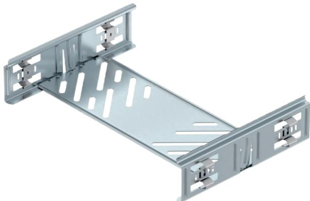
União de caminho de cabos em chapa com fixação rápida para a ligação, sem parafusos, de caminhos de cabos perfurados com uma altura lateral de 60 mm.
