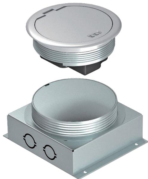
Unidade de montagem redonda com estrutura de proteção do pavimento e unidade de ligação UDL2-120 para montagem em chão de betonilha na área interior. Tampa de encastramento com uma tomada Schuko simples com alvéolos inclinados a 33°. Lateralmente, perto da tomada existe espaço para instalar, opcionalmente, até 2 conectores de dados. No estado fechado, a tampa pode ser limpa a húmido. A profundidade mínima de montagem é de 70 mm. Superfície cromada.
