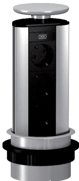
Deskbox retrátil com cabo de ligação para a instalação fixa em mesa, fixação em plástico, pintada conforme a versão. Instalação através de uma abertura de montagem no tampo da mesa (Ø102 mm).
