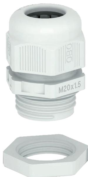
A forma mais rápida e confortável de assegurar o alívio de tensão e a estanquidade em caixas de derivação e armários de distribuição: os bucms certificados V-TEC VM da OBO. Com a borracha de proteção integrada e as lamelas especiais OBO é conseguido o grau de proteção IP68. Alívio de tensão e aperto testados de acordo com a norma DIN EN 62444.
