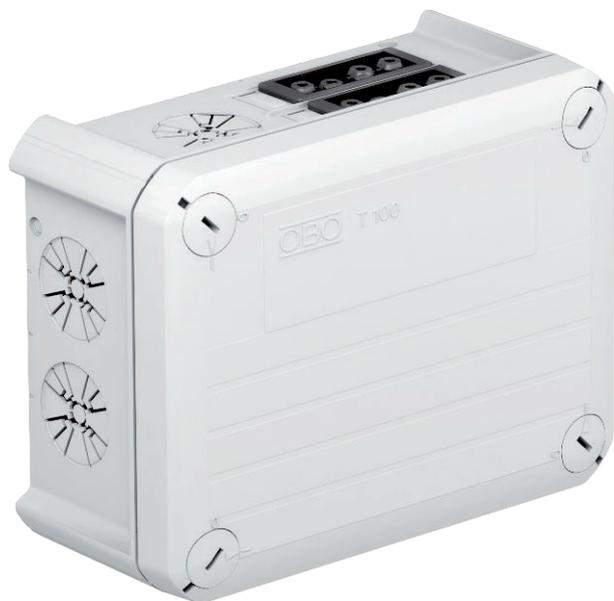
Caixa de derivação com tomadas Wieland 1w3p+1s3p para conectar cabos e condutas em áreas interiores e áreas exteriores protegidas. Formato retangular com entradas quebráveis nas laterais e entradas quebráveis na base. Adequado para a montagem na parede / teto e para a montagem em suportes para caixas de derivação. Com opção de fixação interna e montagem através de parafusos nos cantos. Tampa com fecho rápido, pode ser selada a chumbo. Fabricado em materiais livres de halogéneo.
