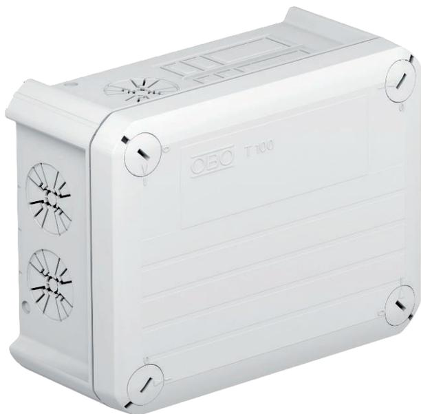
Caixa de derivação para 4 tomadas Wieland de 3-5 polos para conectar cabos e condutas em áreas interiores e áreas exteriores protegidas. Formato retangular com entradas quebráveis nas laterais e entradas quebráveis na base. Adequado para a montagem na parede / teto e para a montagem em suportes para caixas de derivação. Com opção de fixação interna e montagem através de parafusos nos cantos. Tampa com fecho rápido, pode ser selada a chumbo. Fabricado em materiais livres de halogéneo.
