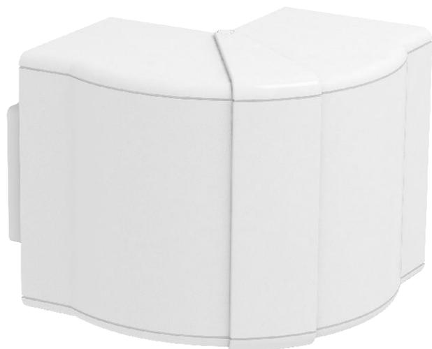
Tampa de ângulo externo em PC/ABS, livre de halogéneos, para alteração da direção das calhas Rapid 80, do sistema GK, GKH, GS e GA. Os acessórios podem variar entre 80° a 100° e podem ser inseridos em calhas simétricas ou assimétricas.
