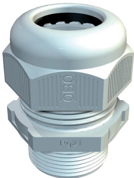
A forma mais rápida e confortável de assegurar o alívio de tensão e a estanquidade em caixas de derivação e armários de distribuição: os bucms certificados V-TEC VM da OBO. Com a borracha de proteção integrada e as lamelas especiais OBO é conseguido o grau de proteção IP68. Alívio de tensão e aperto testados de acordo com a norma DIN EN 62444.
